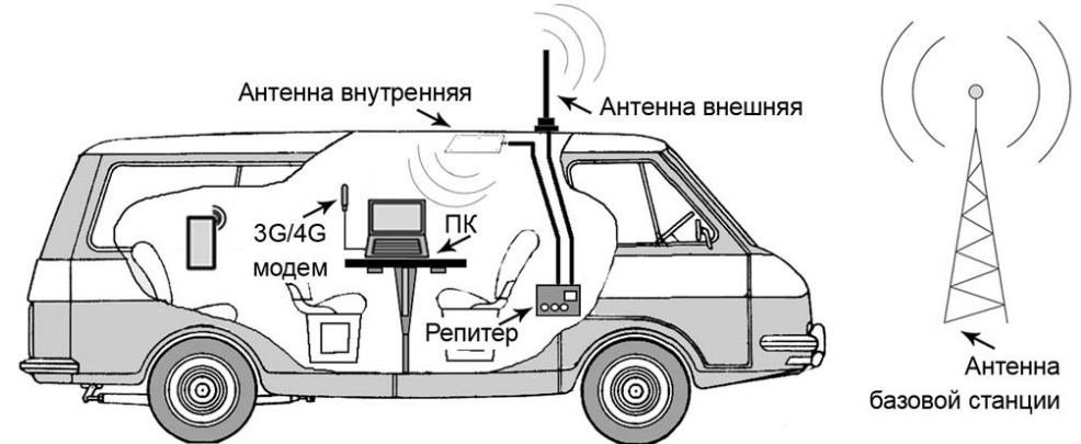
Схема 2 – Пример использования автомобильной антенны при работе с репитером
