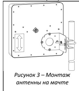
Рисунок 2 – Монтаж антенны на мачте
